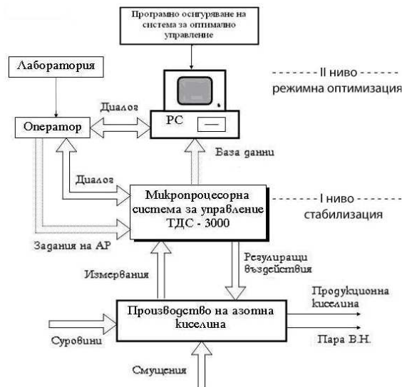
Фиг.2. Йерархична структура на компютъризираната система за управление на производството на азотна киселина
