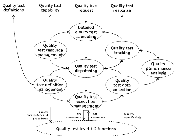
Фиг.2: Функционален модел на оперативното управление на проверката на качество [1]
