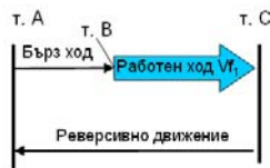
Фиг.2: Цикъл на работа на подавателна маса
